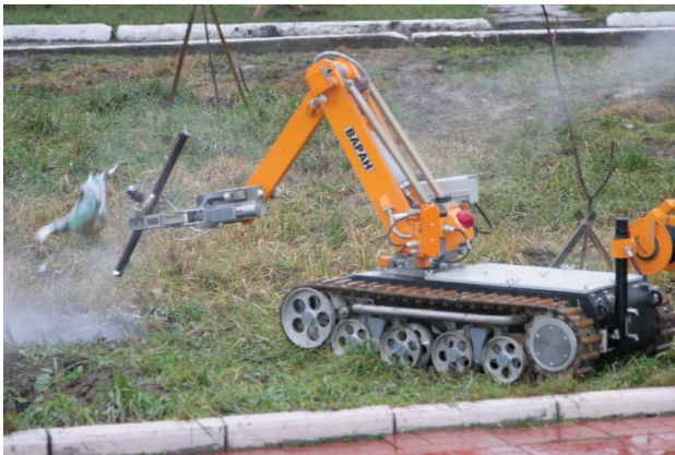
Новейшие роботизированные системы обезвреживания взрывных устройств на испытаниях в ЦИТО
