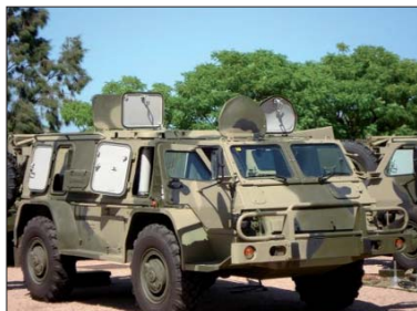
Объемная броневая защита применима для корпусных конструкций машин. Создателям "Водника" (ГАЗ-3937) удалось достигнуть того же эффекта защиты путем создания бронированных модулей
