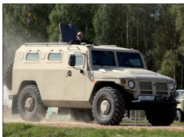
Корпус "Тигра" полностью бронированный и соответствует 5 классу защиты
