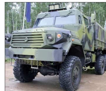
Опыт использования грузовиков в горячих точках показал, что потери личного состава при подрывах меньше на автомобилях с капотной конструкцией кабины. Как правило, на автомобилях большой грузоподъёмности, бронируется только кабина
