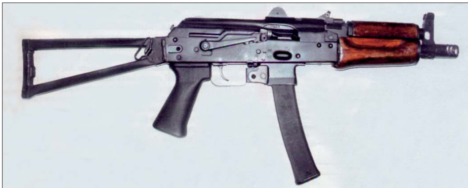
При внесении минимальных изменений в конструкцию АКС74У может быть быстро превращен в качественный пистолет-пулемёт "Витязь"
