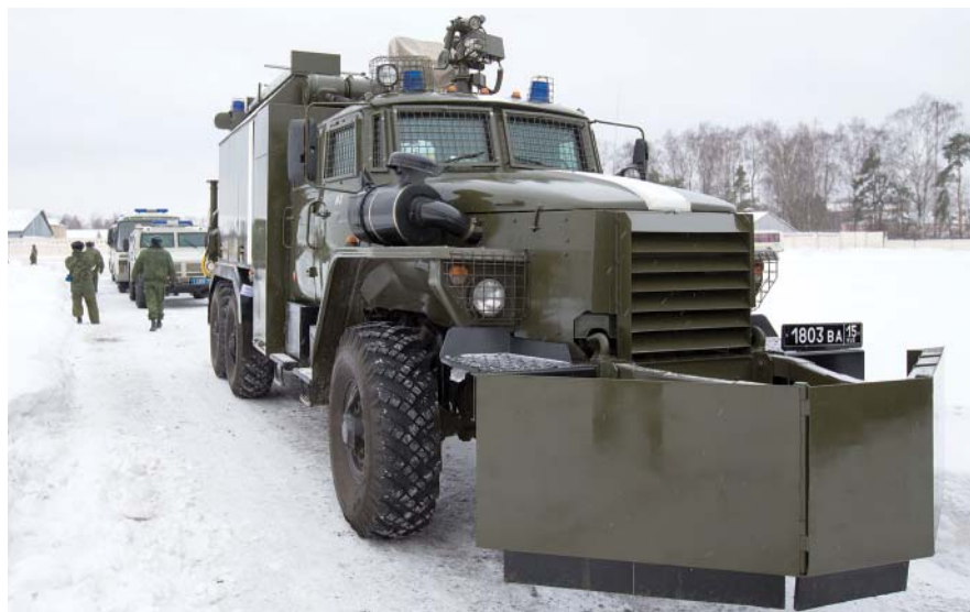
Инженерная машина разграждения «Торнадо»
