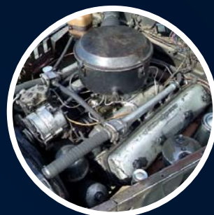
Двигатель ЯМЗ-536 мощностью 310 л.с.
