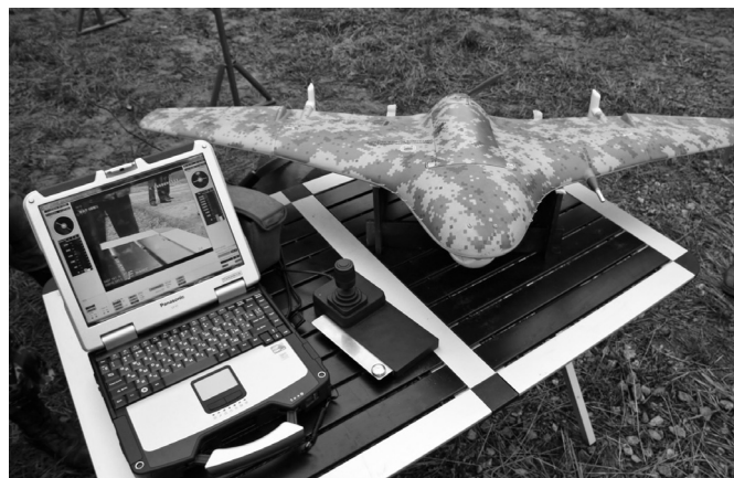
"Элерон-10СВ" предназначен для круглосуточного ведения оптико-электронной разведки, обнаружения объектов разведки, определения их географических координат с отображением их на электронной карте местности и возможностью передачи видео - и служебной информации по радиоканалу
