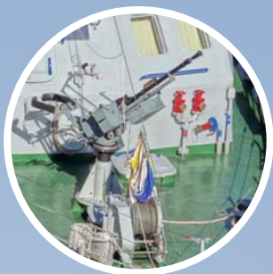
Морская тумбовая пулёмётная установка с 14,5-мм пулёмётом КПВТ
