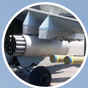
Дополнительное вооружение вертолёт блок НАР и пусковые установки ПТУР
