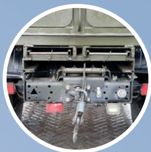
Вид сзади. Хорошо видны лебёдка и выдвижные лестницы
