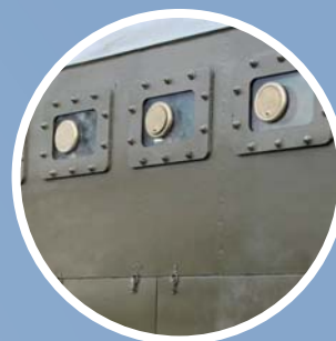
Бронестёкла оснащены бойницами для ведения огня из стрелкового оружия
