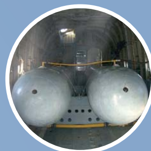
Установленные внутри вертолѣта дополнительные топливные баки
