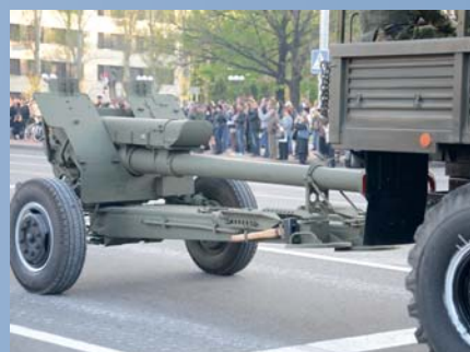
Буксировка Д-30 зацепом шкворневой балки за фаркоп тягача
