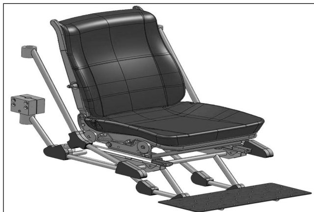
Рис. 14. Антиударное сиденье водителя и командира. Элементы противоминной защиты
