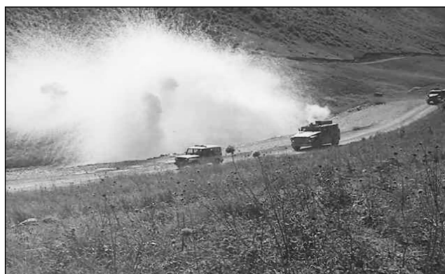
Рис. 12. Применение на СПМ-3 системы постановки мгновенной дымовой завесы
