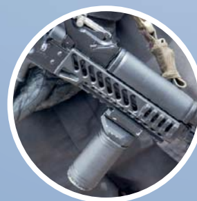
Модернизированное цевье с установленной пистолетной рукояткой
