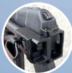
Механизм складывания приклада
