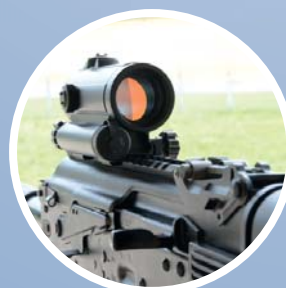
Установленный на крышке ствольной коробки коллиматорный прицел
