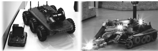
Робототехнические комплексы легкого (КРММ-06) и среднего (МРК-15) классов
