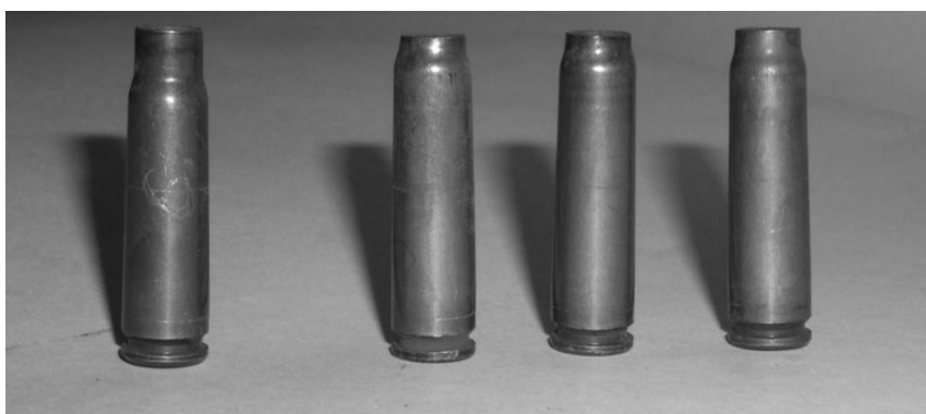
Рис. 5. Деформации гильз при стрельбе с легким затвором
