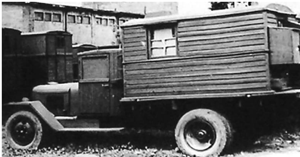
Радиостанция РАФ на базе ЗИС-6
