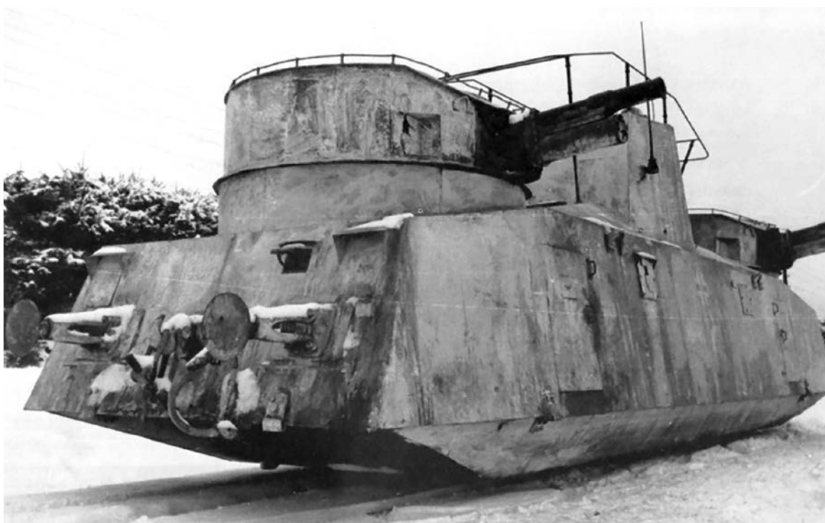
Серийный мотоброневоз бронепоезда войск НКВД по охране железных дорог
