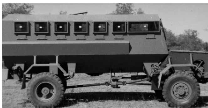
Рис. 4. Этот прототип Hippo Mk II, разработанный Armscor, использовал половину шасси и половину монокок
