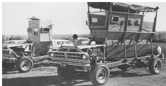
Рис. 1. Telefoonhokkie (слева) и Kameel (справа) – первые новаторские конструкции МРАР, установленные на шасси Ford F250
