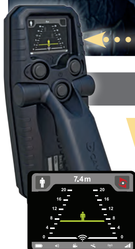
Ручной поисковый радар для запреградного обнаружения живых объектов «Хавер-100»
