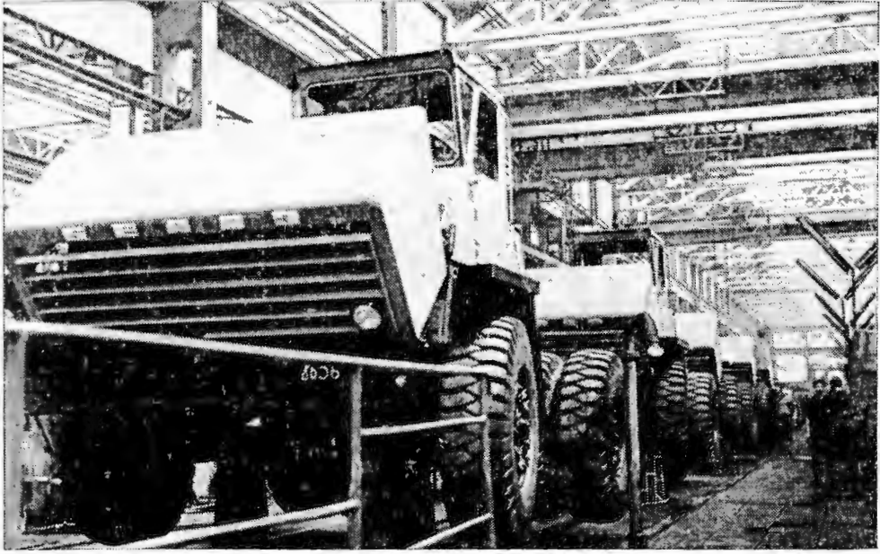
Белорусский автомобильный завод. На снимке: сборка 27-тонных автомобилей «Белаз», удостоенных Знака качества. Фотохроника ТАСС.
