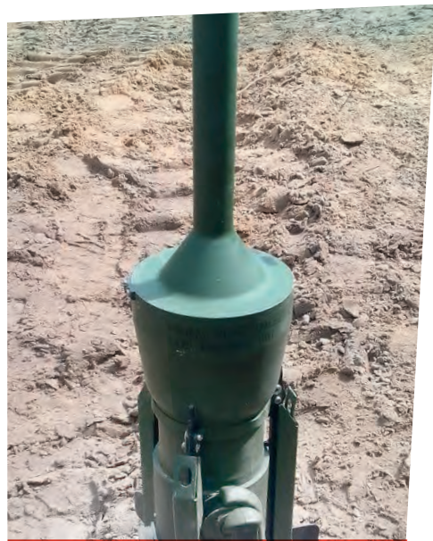
Редкий и опасный трофей – немецкая противотанковая мина PARM. Может поражать технику в борт на расстоянии от 5 до 100 метров. Оснащена батареей, обеспечивающей нахождение в боевом положении до 40 суток.
