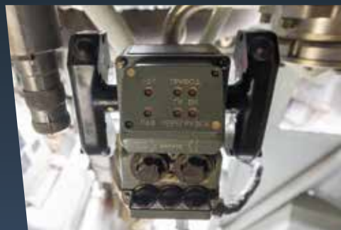
Электроприводный механизм управления башенной пушечно-пулемётной установкой
