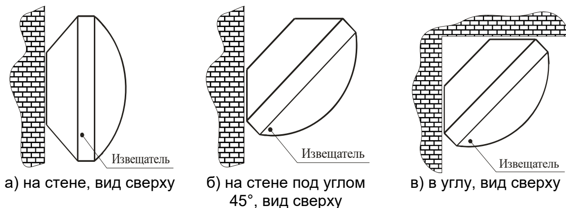
Рисунок 1.11 – Установка извещателя без кронштейна
