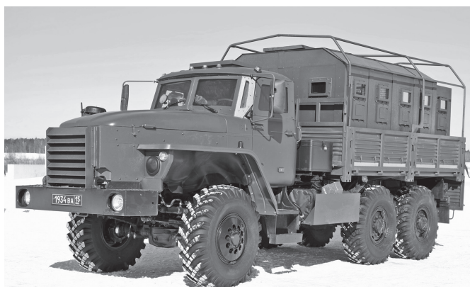
Рис. 8. Автобус специальный бронированный «Федерал-42591» на базе Урал-4320
